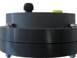
**TESTE DI CHIUSURA POZZO IN PVC** a pressione con foro centrale tappino e passacavo. Rispetto alle normali teste di chiusura del pozzo hanno un prezzo inferiore e sono più veloci da applicare poiché non hanno viti e bulloni, l'isolamento del pozzo dall'ambiente esterno è comunque garantito da una guarnizione in gomma (o-ring) posizionata all'interno.
