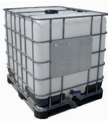
**CISTERNETTA IN HDPE** per il trasporto dei liquidi, con struttura esterna in metallo, dotata di foro di ingresso Ø 135 mm chiuso da coperchio con guarnizione sulla parte superiore e foro di uscita a Ø 50 mm con rubinetto nella parte inferiore. Capacità 1000 lt, dimensioni: altezza 116,30 cm, base 120 x 100 cm.
