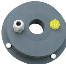
**TESTE DI CHIUSURA POZZO IN PVC** con foro centrale tappino e passacavo. Le teste sono composte da una flangia ed una contro flangia che vengono accoppiate e serrate con viti e bulloni e sono utilizzate per assicurare la protezione del pozzo da possibili contaminazioni.
