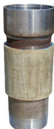
**GIUNTO DIELETTRICO**. Fondamentale per assicurare l'isolamento elettrico permanente tra un materiale e l'altro quando la colonna è composta da tubi di materiali diversi (es. acciaio inox e acciaio al carbonio), il giunto dielettrico inoltre protegge la parte di colonna a valle da eventuali correnti vaganti.
